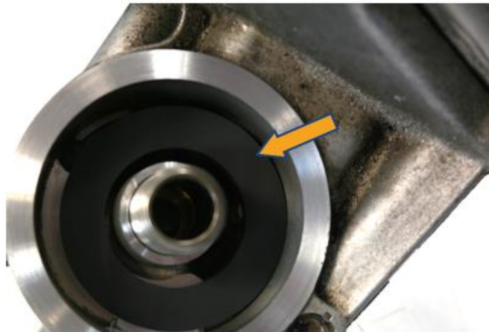
Ilustración 4: Junta depositada en la base de montaje
